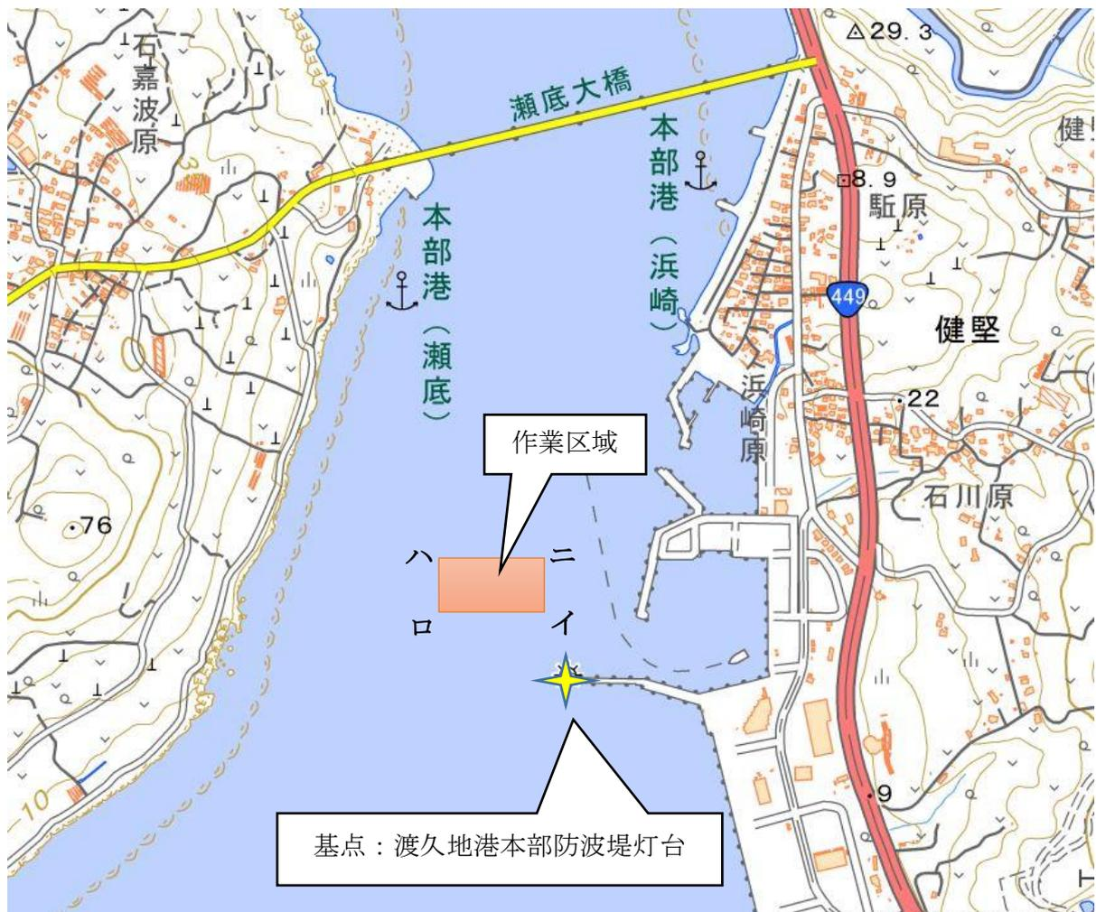
作業は潜水士船からエントリーした潜水士1名により、作業区域内を簡易探査機（型式●●）を使用して磁気異常物の探査を行います。（探査有効深度：2m）
